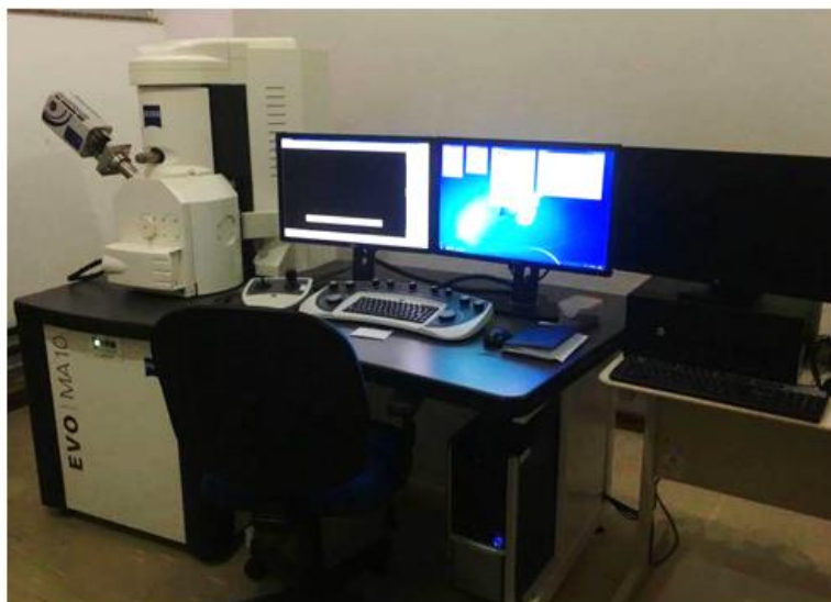
Figura 07 – Microscópio Eletrônico de Varredura - MEV convencional de filamento de tungstênio Zeiss EVO MA10, Laboratório de Microanálises da UFPA. Fonte: Autor, 2018.
