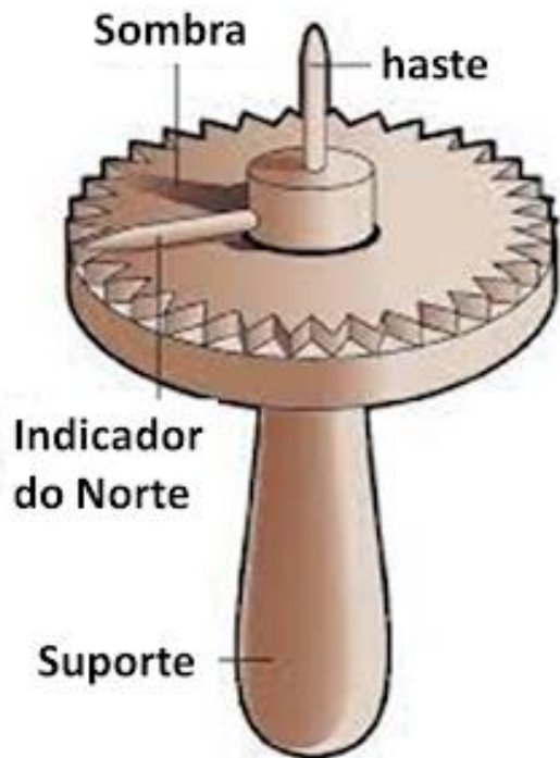
Fig. 2- Esquema de funcionamento de uma bússola solar. (Imagem: https://www.livrosvikings.com.br/post/bussola-solar-nordica )
